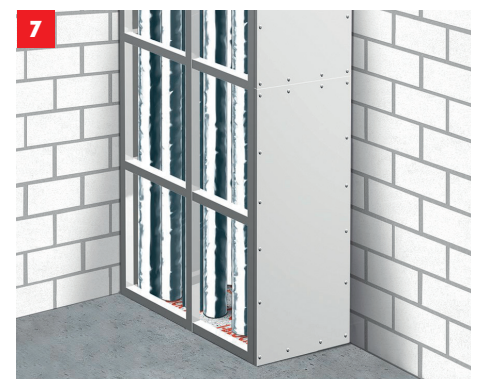
7 Verkleiden der Schachtwand. Fertig.
