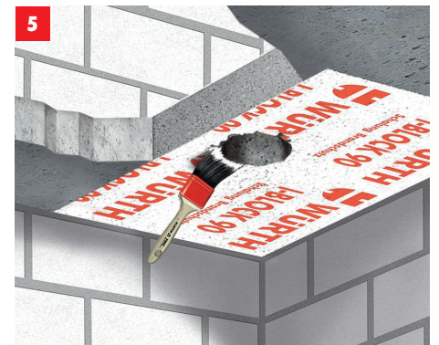
5 Nachbeschichten der Bohrlochränder und Schnittkanten mit Ablationsbeschichtung auf der Unterseite des I-Block 90®
