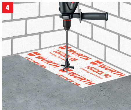
4 Einfaches Bohren der Durchführungen, z.B. mit Leichtbetonfräser, Zylinderstange, Bohrkronen, Säbelsäge
