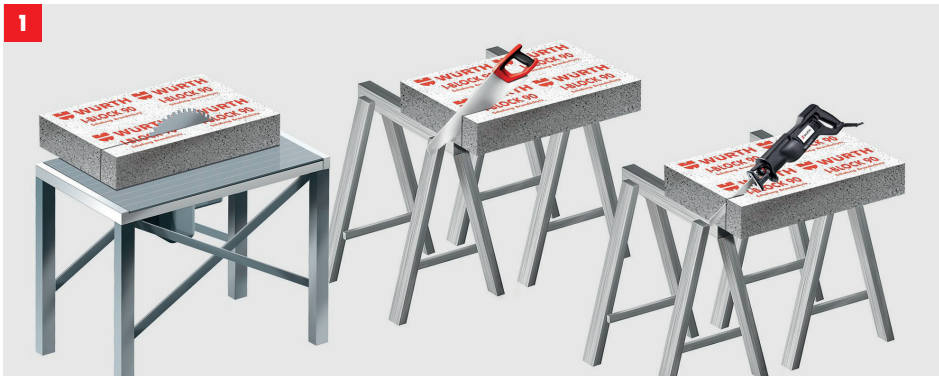
1 Zuschneiden des I-Block 90® z.B. mittels Kreis-, Hand- oder Säbelsäge
